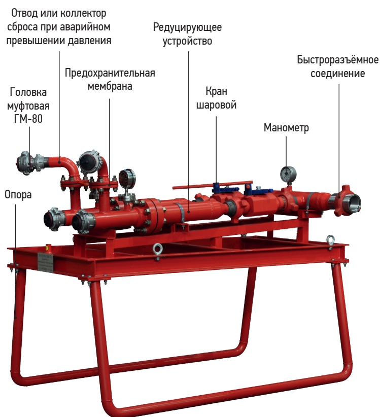
РИСУНОК 1 – КОНСТРУКЦИЯ БРУ БРУСТВЕР (2Р)-21,0
