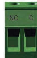
Рис. 15 Релейный выход в блоке управления
