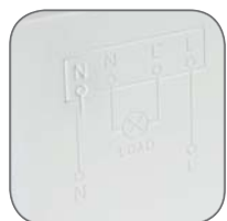
Схема подключения указана на корпусе изделия
