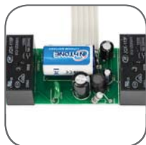
Два встроенных реле на токи до 16 А
